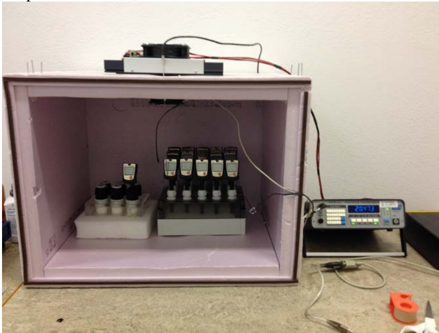
Figur 2.9 Lagringskammare av extruderad cellplast XPS med temperaturstyrning för lagring av sensorer under saltkontroll.
