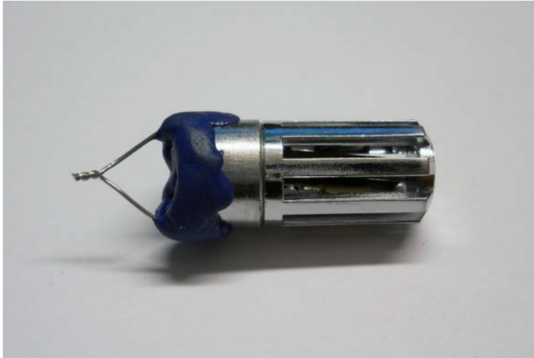
Figur 2.19 Kapad och förseglad HMP44-givare med sensor och gallerskydd utan filter.
