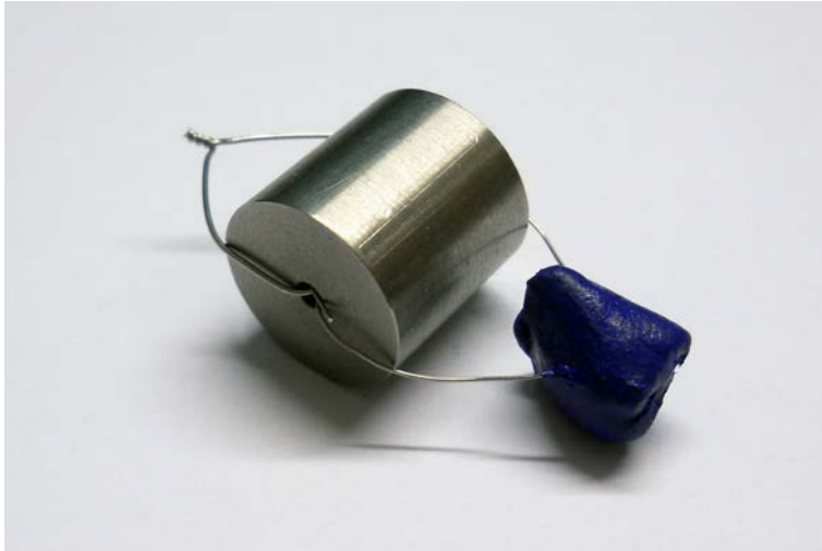
Figur 2.28 Tätningsmassa av butyl (Platon) monterad tillsammans med referensvikt.
