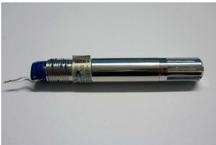
Figur 2.21 HMP110-givare med sensor, gallerskydd samt pappersfilter och förseglat kabeluttag i bakstycket.
