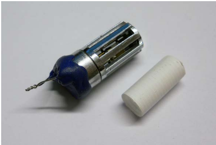
Figur 2.20 Kapad och förseglad HMP44-givare med sensor, gallerskydd och demonterat pappersfilter.
