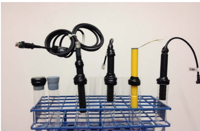
Figur 2.29 RF-sensorer monterade i provrör av glas för kontroll av anslutningarnas täthet.
