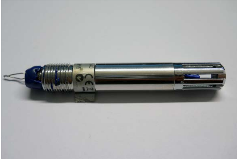
Figur 2.22 HMP110-givare försedd med gallerskydd utan filter och förseglat kabeluttag i bakstycket.
