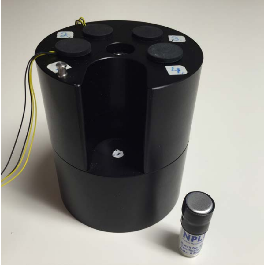
Figur 2.8 HumiGuard referensblock och referenscell som används för kontroll av RF-sensornas drift under mätperioden.
