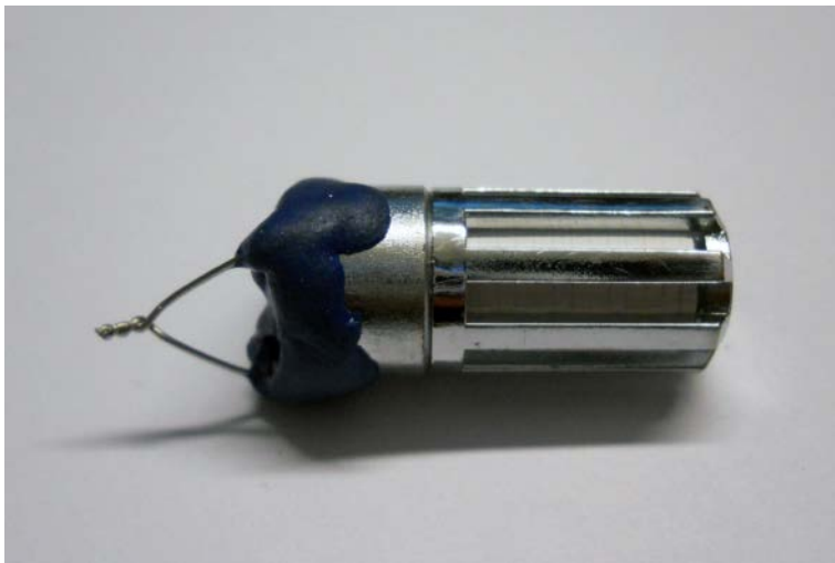
Figur 2.18 Kapad och förseglad HMP44-givare med sensor, gallerskydd och pappersfilter.
