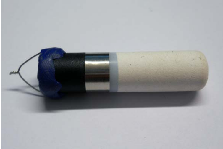
Figur 2.25 Kapad och förseglad 635-givare med sensor och teflonfilter.
