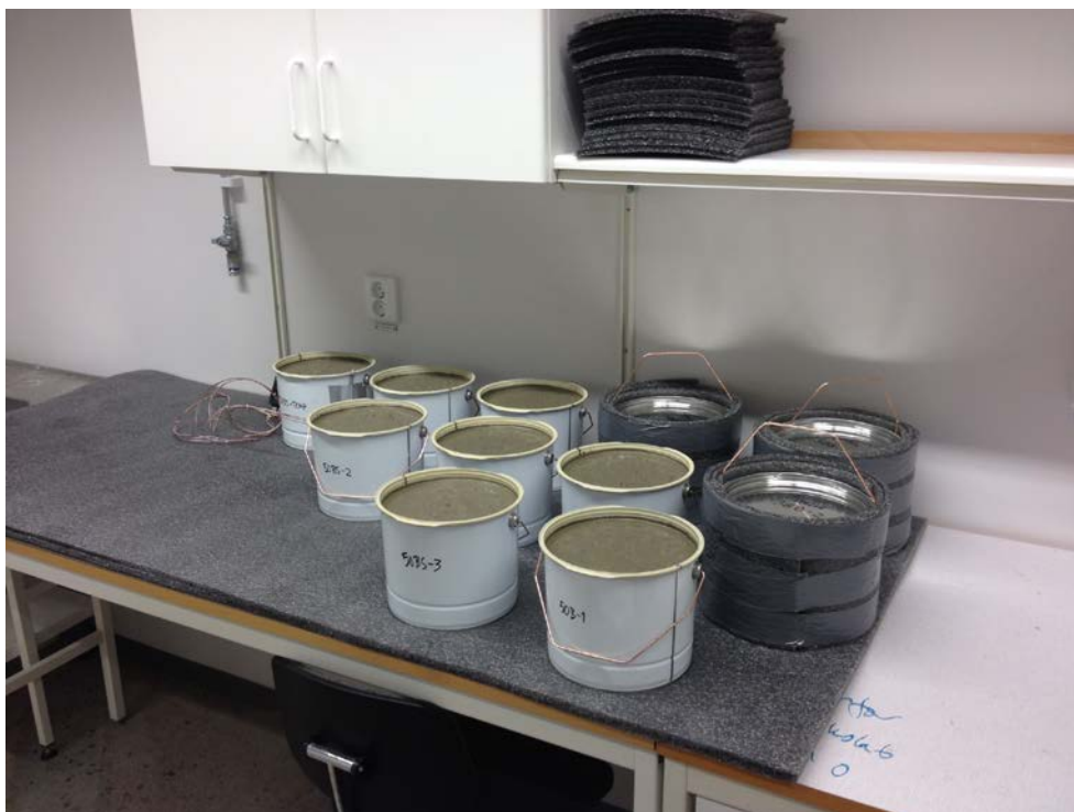
Figur 2.1 Lagring av provkroppar vilka göts i 5-liters burkar av plåt. De tre proven till höger i figuren, med beteckning 38B, var under lagringen försedda med lock för försegling samt betongtäckmatta längs mantelytan för värmeisolering. Övriga prov tilläts enkelsidig uttorkning under hela lagringsförloppet.
