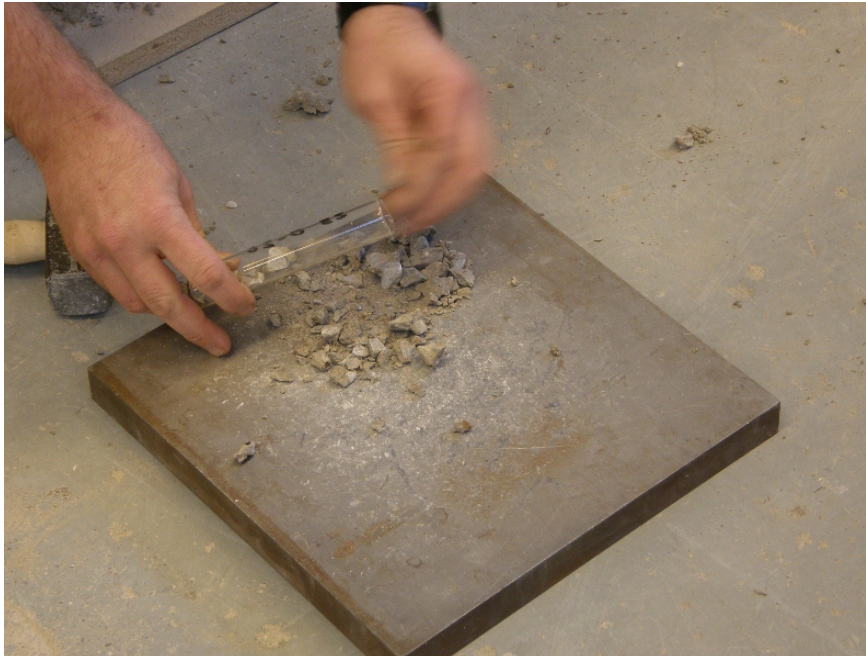
Figur 2.14 Uttagna provbitar från respektive djup placeras i glasrör som förseglas med gummikork i väntan på RF-mätning.
