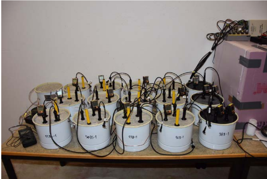
Figur 2.10 RF-givare av olika modell och fabrikat monterade i provkroppar med placering enligt tabell 2.1. Tre av provkropparna är förseglade vilka kan observeras till höger i bild, genom att överytan är belagd med butylduk.
